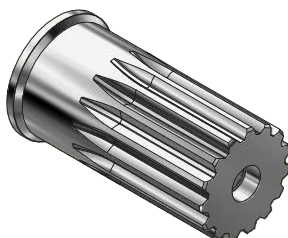
SHAFT W DIN 5482 B25 x 22h9 14zx1.6mx30Px9h
